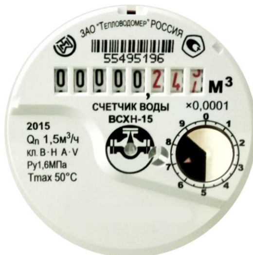
Рисунок 1. Счётный механизм счётчика ВСХН-15
